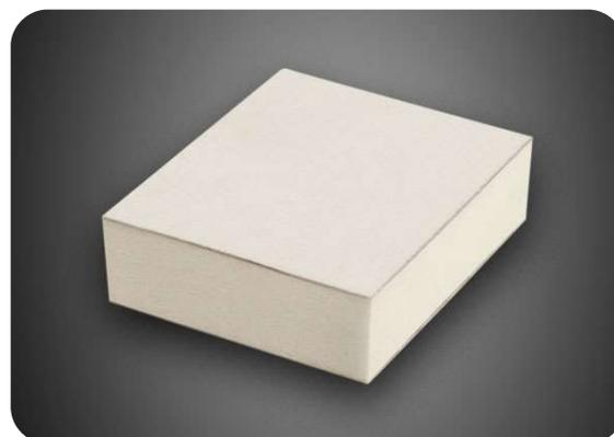
**POLIISO® VV** è un pannello per l'isolamento termico costituito da una schiuma polyiso (poliuretano espanso) rigida a celle chiuse, di colore giallo, espansa senza l'impiego di CFC o HCFC fra due supporti di velovetro saturato. I pannelli dichiarano valori di  $\lambda_D$  pari a 0,027 W/mK per spessori fino a 40 mm, 0,026 W/mK per spessori da 50 mm a 90 mm e 0,025 W/mK per spessori superiori secondo la norma europea EN 13165.
