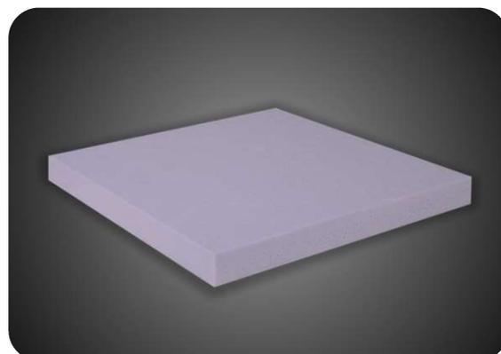
**X-FOAM® MLB** è una lastra per l'isolamento termico costituita da polistirene estruso monostrato di colore indaco, senza pelle di estrusione e con i 4 bordi dritti. Le lastre dichiarano valori di resistenza alla compressione da 200 kPa a 300 kPa a seconda dello spessore. Hanno una larghezza pari a 600 mm, lunghezza 3000 mm e spessori disponibili da 20 a 100 mm. **X-FOAM MLB** è classificato al fuoco EUROCLASSE E secondo la normativa europea EN 13501-1.
